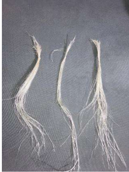
Şekil 9. Suda çürütme sonucu elde edilen lifler
