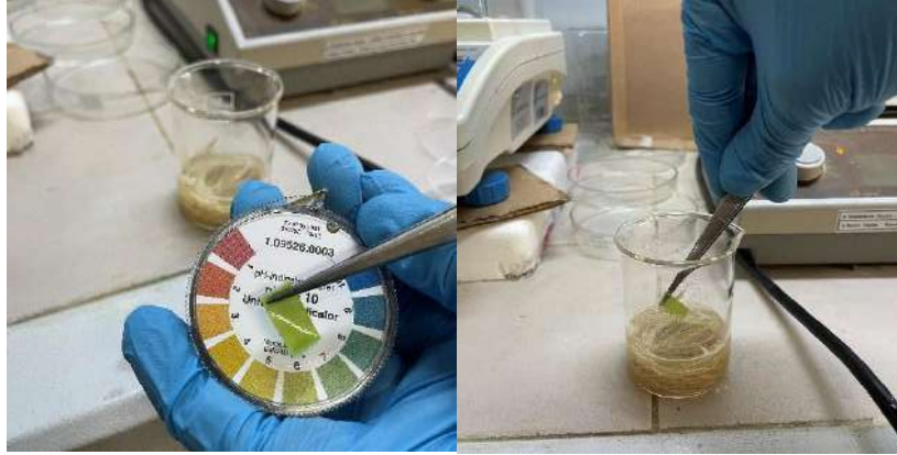
Şekil 4: Bamyalı liflerinin hazırlandığı ortamın pH takibi ve pH ölçümü
