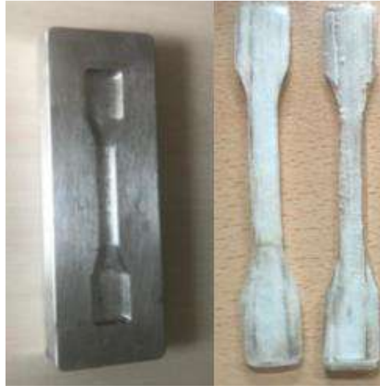
Şekil 1. Numune Kalıbı ve Üretilen Kompozit Numuneler
