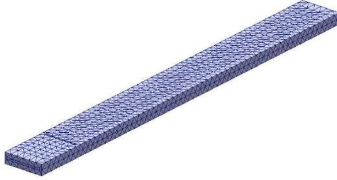
Şekil 4. Kompozit Çubuklardaki Mesh İşlemi
