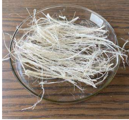
Şekil 8: Enzimekanik işlem uygulanmış kuruyan bamya başak lifi
