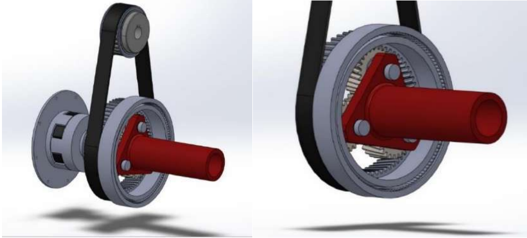
Şekil 4. a) Dişli ve kayış kasnak sistemi; b) Çıkış mili bağlantısı
