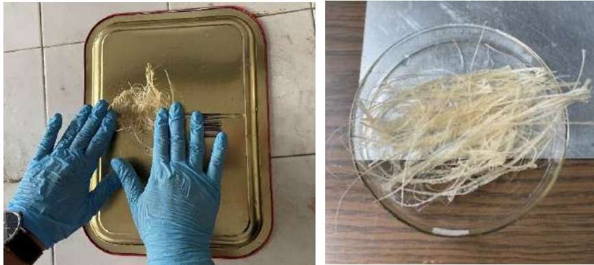
Şekil 6: Bamyalı liflerine uygulanan mekanik işlem ve kurumaya bırakılan bamyalı lifleri
