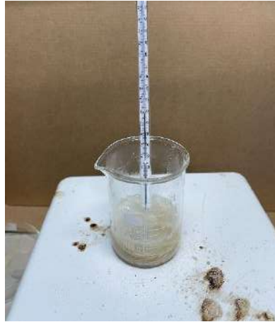
Şekil 3: Sıcaklık takibi: 60°C sabit sıcaklıkta çözelti içindeki bamya lifleri
