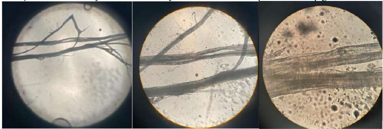
Şekil 10: Enzimekanik işlem görmüş bamya lifinin farklı büyütme oranlarındaki optik mikroskop görüntüsü
