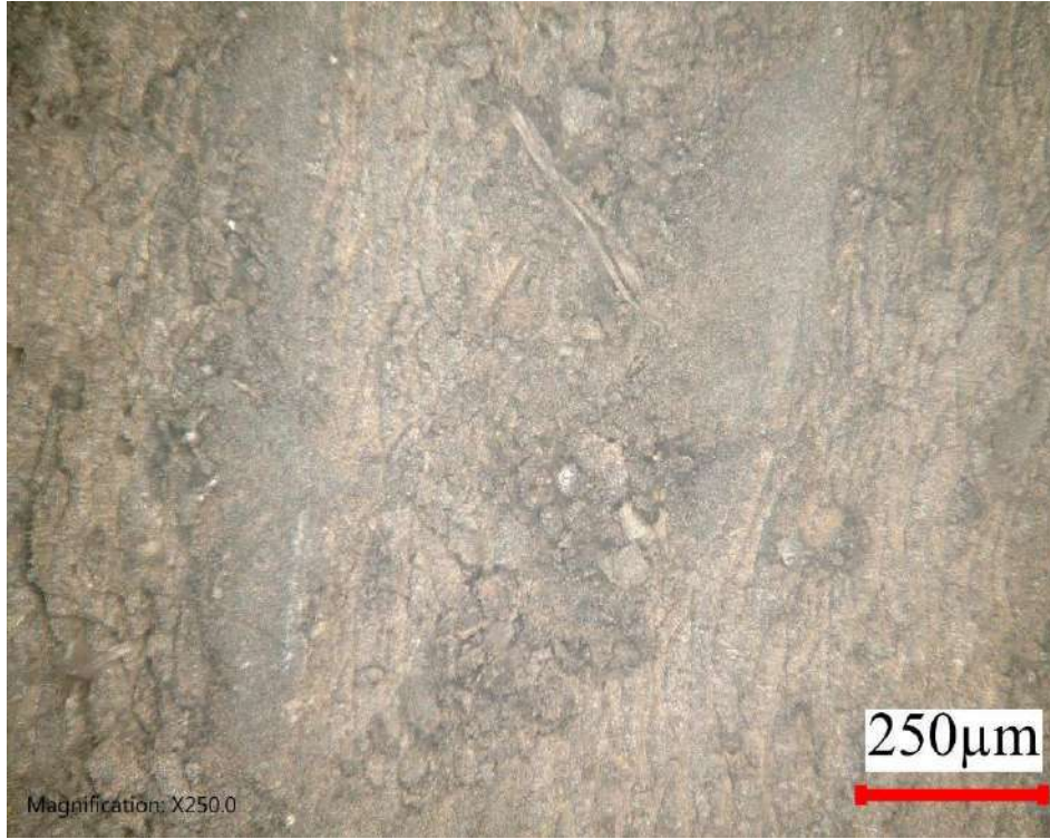
Görsel 4.5.8: Sekizinci Deney Parçasının İşlem Sonucu Yüzeyinin Mikroskopik Görüntüsü
